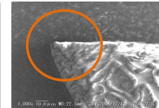
図6. 割裂+面押し部断面拡大(×15・×1000)
