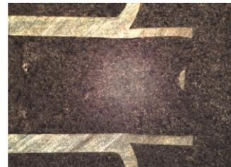
図5. 割裂+面押し部断面(×10)
